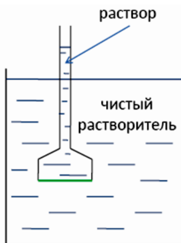
Рис. 6.1.5. Опыт по определению осмотического давления
